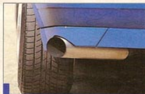
Der Papmahl-Auspuff mit 75-mm-Endrohr wurde seitlich herausgeführt
