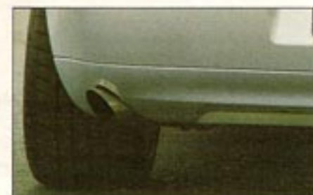
Das 83-mm-Endrohr der Eigenbau-Auspuffanlage führte Axel zur Seite heraus
