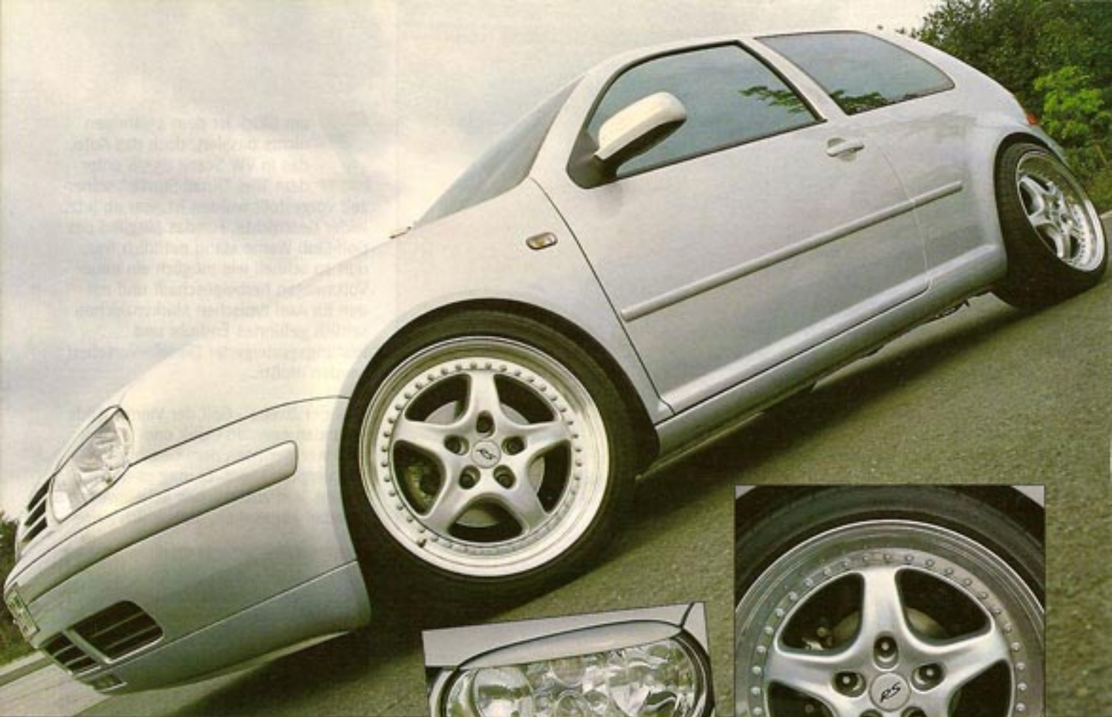
Das KW-Fahrwerk legt den Golf 60 mm/45 mm w/h tiefer
